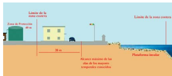
Figura 35. Límite hacia tierra de la ZC y la ZP del tipo de costa 6
