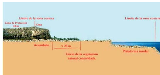
Figura 26. Límite hacia tierra de la ZC y la ZP del tipo de costa 1b)
